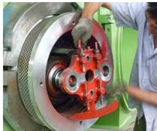
Figura 33. Ajuste de rodillos
