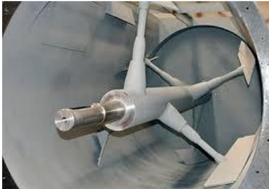
Figura 29. Vista externa de la mezcladora horizontal de paletas ALPROSA
