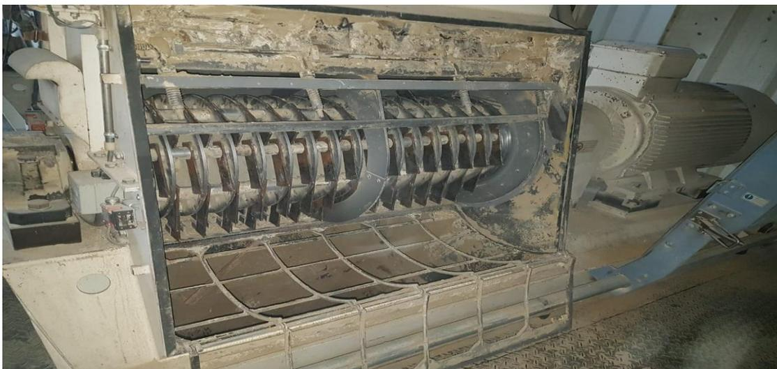
Figura 23. Esquema frontal y lateral de un molino de martillos
