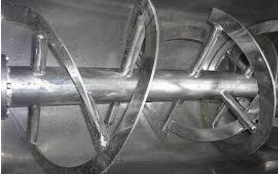
Figura 28. Mezcladora horizontal de paletas
