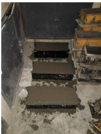
**Figura 4-12: Colocación del concreto en moldes metálicos**
