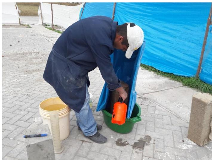
**Figura 4-14: Curado por método de aspersión**
