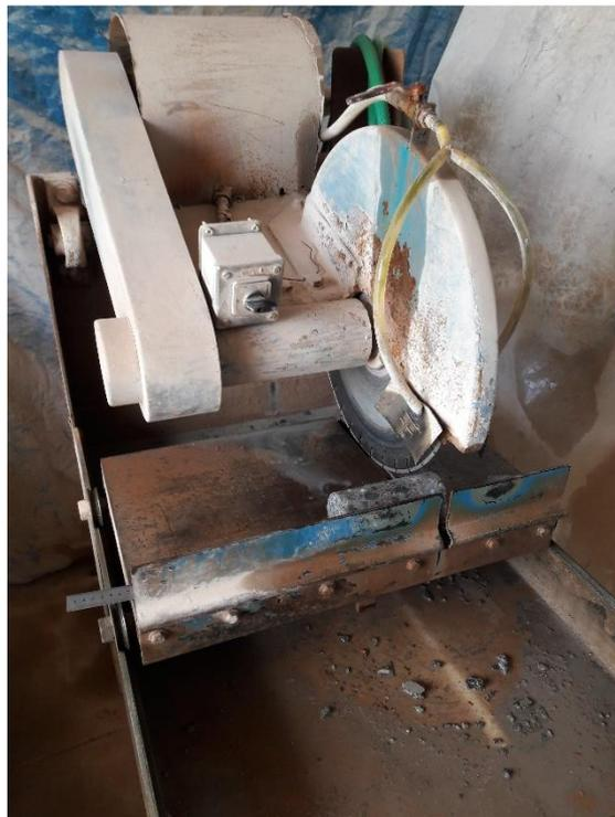
**Figura 4-20: Aserrado de las bases del testigo diamantino
