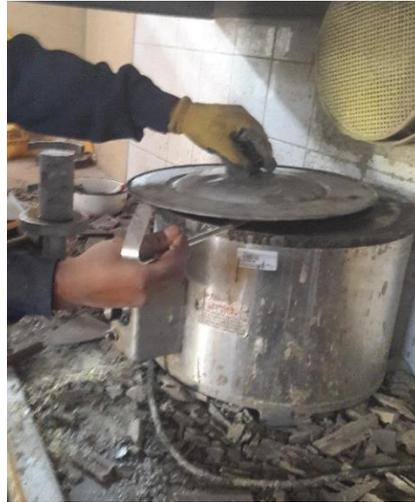
**Figura 4-8: Olla eléctrica para fundir azufre**
