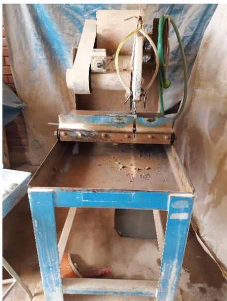
**Figura 4-7: Mesa cortadora circular de concreto**
