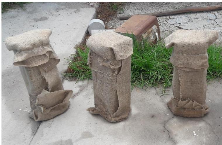
**Figura 4-15: Curado húmedo con membrana de yute**
