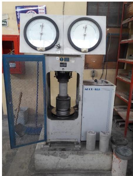
**Figura 4-9: Prensa de concreto SOILTEST**
