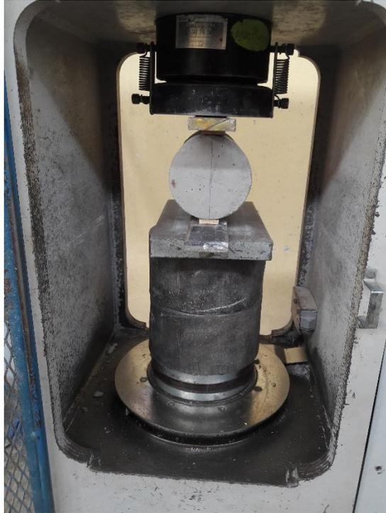
**Figura 4-24: Ensayo de Resistencia a la tracción indirecta por compresión
