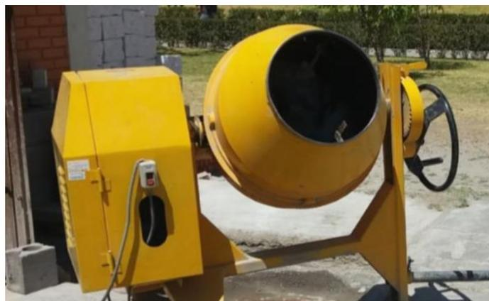
**Figura 4-11: Mezcladora de concreto empleado con capacidad de ½ bolsa**
