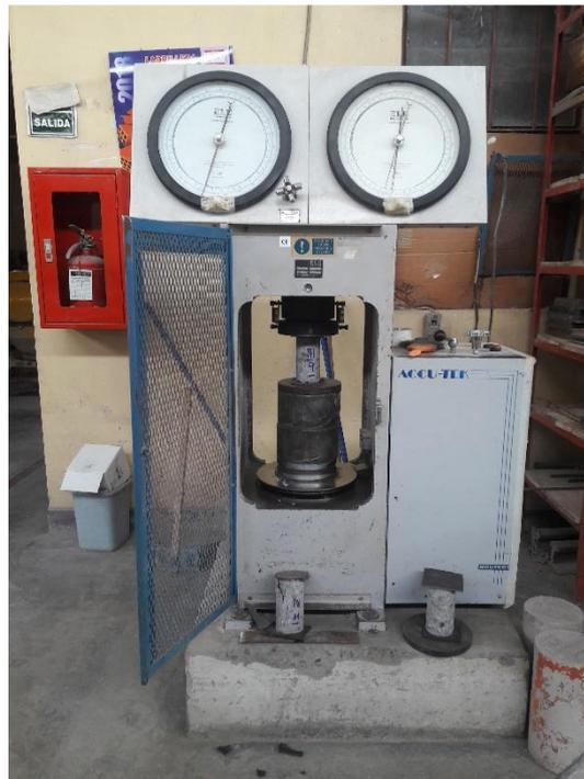
**Figura 4-23: Ensayo de resistencia a la compresión**
