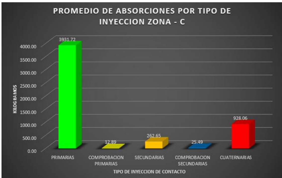
Figura 6.6. Promedio de absorciones de lechada en la zona – C del túnel de desvío.
